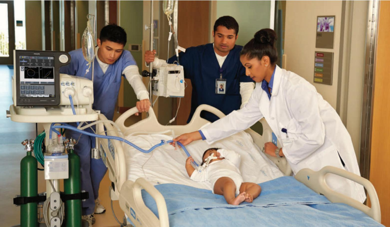
Ein integrierter Notstromakku mit einer Kapazität von vier Stunden dient als Backup für den Fall längerer Stromausfälle und ermöglicht nahtlose Übergänge bei Transporten innerhalb des Krankenhauses.
