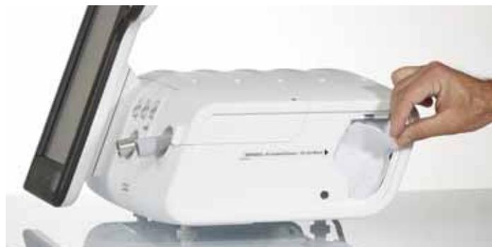
*Abbildung 10-8: Ersetzen des Luftansaugfilters*
