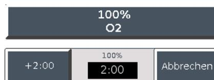
Jedes Mal, wenn die Schaltfläche gedrückt wird, erfolgt 2 Minuten lang 100 % O<sub>2</sub>. Wird die Schaltfläche **2:00** gedrückt, fügt das V680 der verbleibenden Zeit des ersten 2-Minuten-Zählers eine weitere zweiminütige Phase hinzu. Die Schaltfläche **2:00** wird nach dem Drücken deaktiviert, bis weniger als 2 Minuten verbleiben, woraufhin sie wieder aktiviert wird. Durch Drücken der Schaltfläche **Abbrechen** wird die 100 % O<sub>2</sub>-Zufuhr beendet.
