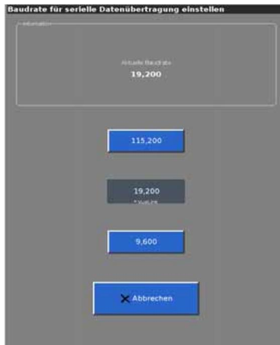
Abbildung E-9: Bildschirm Baudrate für serielle Datenübertragung einstellen
