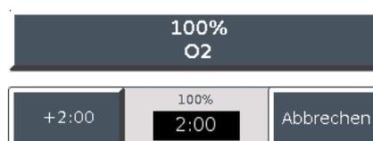
Jedes Mal, wenn die Schaltfläche gedrückt wird, erfolgt 2 Minuten lang 100 % O<sub>2</sub>. Wird die Schaltfläche **2:00** gedrückt, fügt das V680 der verbleibenden Zeit des ersten 2-Minuten-Zählers eine weitere zweiminütige Phase hinzu. Die Schaltfläche **2:00** wird nach dem Drücken deaktiviert, bis weniger als 2 Minuten verbleiben, woraufhin sie wieder aktiviert wird. Durch Drücken der Schaltfläche **Abbrechen** wird die 100 % O<sub>2</sub>-Zufuhr beendet.
