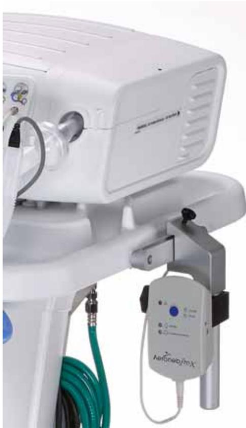
Abbildung 5-10: Installieren eines Aeroneb Pro-Verneblers
