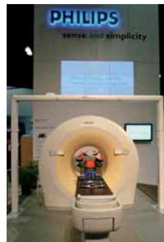
Nya Gemini TF Big Bore får 85 cm gantryöppning på både PET- och CT-delen.
